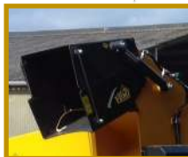
Vaste blaaspijp fixed blowpipe
